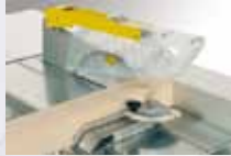
Sicherheitsschutzhaube mit selbstöffnender und schließender Funktion
